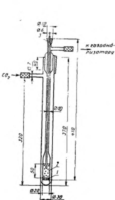
1—пластинка из дробленого кварца; 2—проба кокса; 3—чехол для термометра
