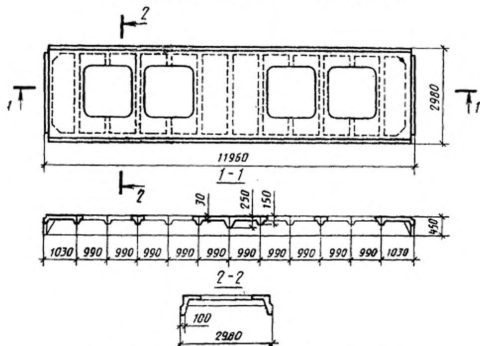
С двумя проемами размерами 2600×2700 мм
