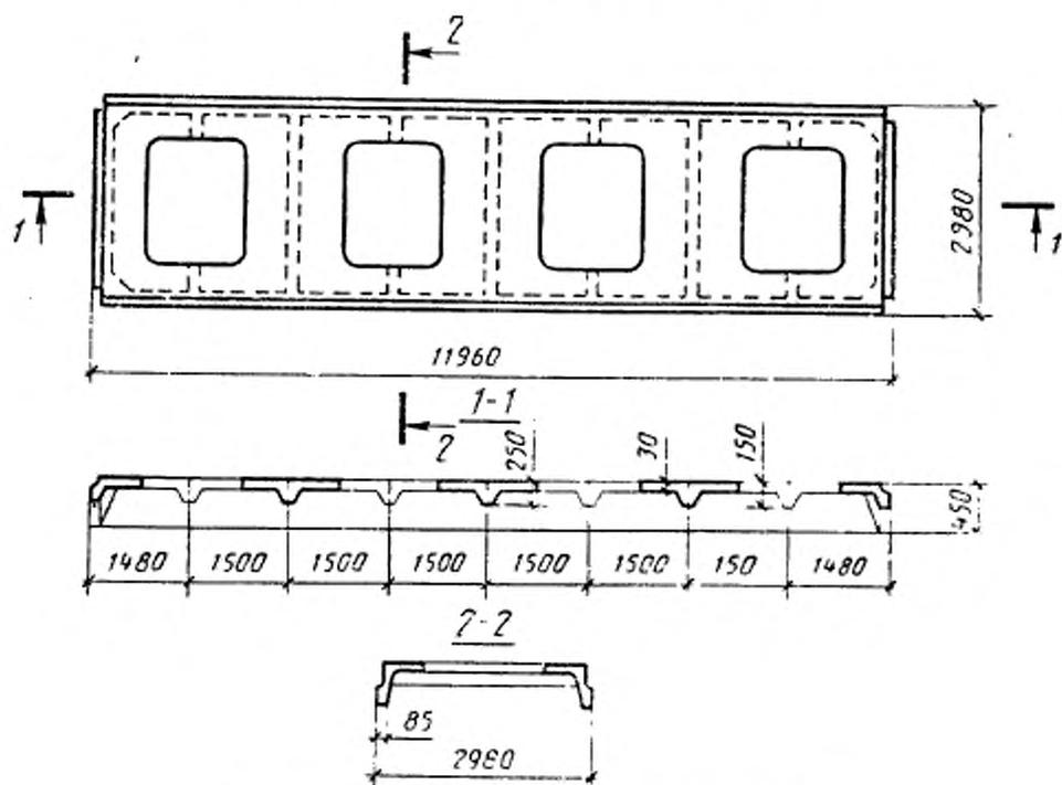
С двумя проемами размерами 2600×2700 мм
