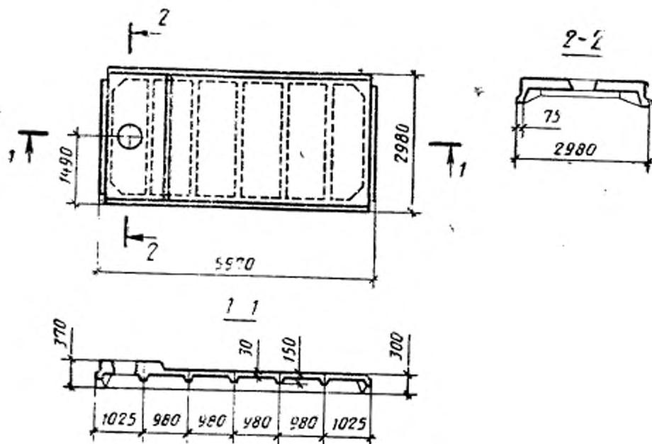
С проемом диаметром 1000 или 1450 мм
