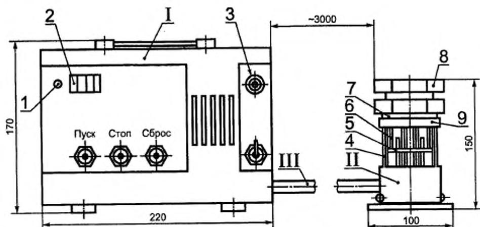
*I* — блок регистрации; *II* — датчик обнаружения; *III* — электрический кабель; *I* — индикатор проникновения агрессивной среды; 2 — счетчик времени; 3 — сигнальная лампа; 4 — цилиндрический корпус датчика обнаружения; 5 — перфорированная пластина; 6 — микротерморезисторы; 7 — контейнер с обоймой; 8 — стакан контейнера с прижимной гайкой; 9 — посадочное гнездо
