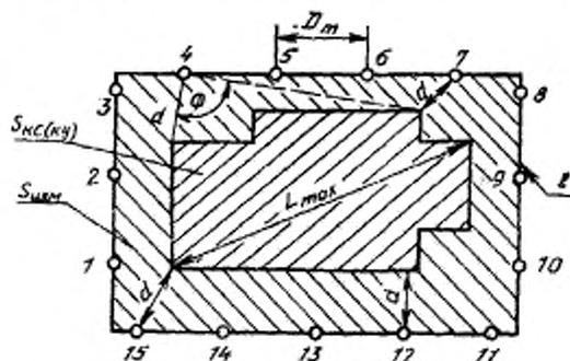
1-15 — точки измерения;  $\Phi$  — угол обзора;  $D_{изм}$  — расстояние между точками измерения;  $d$  — измерительное расстояние;  $L_{max}$  — наибольший размер по площади КС (КУ);  $S_{ис(ку)}$  — площадь КС (КУ);  $S_{изм}$  — измерительная площадь;  $l$  — длина измерительного контура
