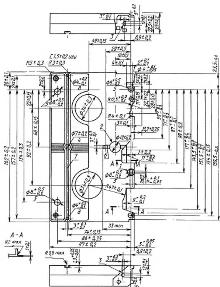
1 — базовое отверстие; 2, 3 — отверстия для прохождения света сенсорного датчика; 4 — отверстие для освобождения тормоза катушки; 5 — опорные поверхности. Отклонение от плоскости опорных поверхностей не должно быть более 0,2 мм; 6, 7 — направляющий паз для предотвращения неправильной установки видеокассеты в видеомагнитофон; 8 — положение вспомогательного отверстия
