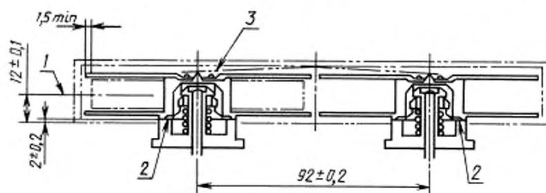
1 — центр магнитной ленты; 2 — высота основания сердечника катушки от базовой плоскости;
