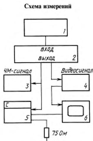
1 — генератор телевизионных сигналов; 2 — видеомегнитофон измерительный; 3 — осциллограф; 4 — измеритель отношения сигнал/шум; 5 — счетчик выпадений сигнала; 6 — видеоконтрольное устройство
