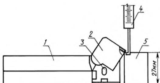
1 — видеокассета; 2 — защитная крышка; 3 — защелка;
