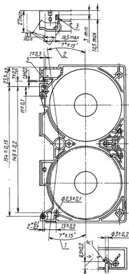
1 — угол падения света сенсорного датчика на стороне подающей катушки; 2 — угол падения света сенсорного датчика на стороне принимающей катушки; 3 — положение толкателя, открывающего (разблокирующего) защитную крышку видеокассеты; 4 — положение штифта толкателя видеомагнитофона, освобождающего (разблокирующего) узел стопорения видеокассеты; 5 — положение рычага (толкателя) видеомагнитофона для открывания защитной крышки видеокассеты
