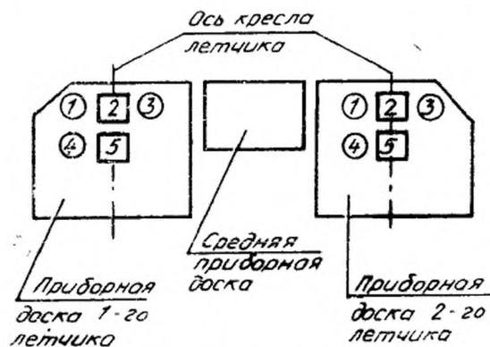
1 — индикатор приборной скорости; 2 — основной пилотажный индикатор; 3 — вариометр; 4 — высотомер; 5 — основной навигационный индикатор
