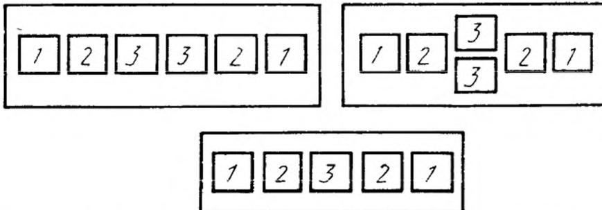
1 — индикатор вертикальной обстановки; 2 — индикатор горизонтальной обстановки; 3 — индикатор контроля силовой установки и систем вертолета
