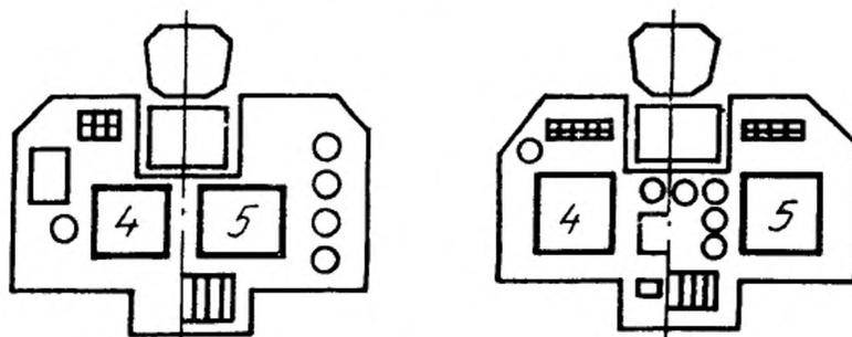
4 — видеоконтрольное устройство; 5 — картографический индикатор
