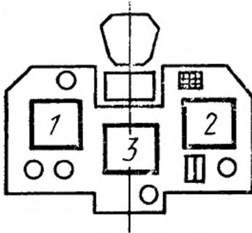
1 — индикатор вертикальной обстановки; 2 — индикатор горизонтальной обстановки; 3 — индикатор контроля силовой установки и систем вертолета
