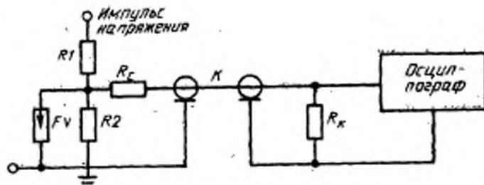
FV — разрядник; K — коаксиальная кабель; R1, R2 — сопротивления высоковольтной и низковольтной частей делителя соответственно; R<sub>c</sub> — согласующее сопротивление; R<sub>k</sub> — волновое сопротивление кабеля
