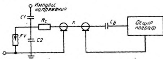
FV — разрядник; K — коаксиальный кабель;  $C_1$ ,  $C_2$  — емкости высоковольтной и низковольтной частей делителя соответственно;  $C_0$  — блокировочный конденсатор;  $R_c$  — согласующее сопротивление
