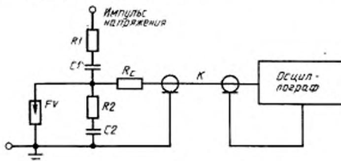
$FV$  — разрядник;  $K$  — коаксиальный кабель;  $R_1, R_2$  — демпфирующие сопротивления высоковольтной и низковольтной частей делителя соответственно;  $C_1, C_2$  — емкости высоковольтной и низковольтной частей делителя соответственно;  $R_C$  — согласующее сопротивление
