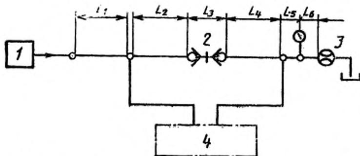
$L_1, L_4=10$  диаметров соединительной трубы или условных проходов муфты;  $L_2, L_4, L_5=5$  диаметров соединительной трубы или условных проходов муфты;  $L_3=$  муфта плюс концевые штуцеры; 1 — источник получения жидкости; 2 — муфта; 3 — кран; 4 — устройство измерения перепада давления
