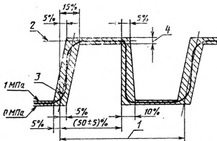
1 — один импульс цикла; 2 — максимальное давление при испытании; 3 — 15 % давления при испытании; 4 —  $\pm 5$  % давления при испытании
