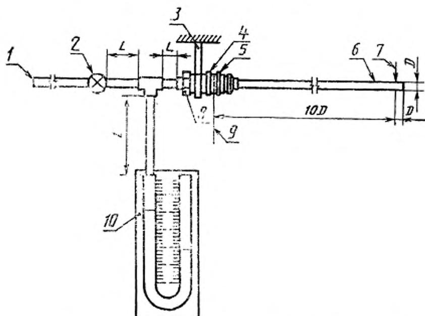
$D$  — условный проход муфты;  $L=15 D_{\max}$ ; 1 — вакуумный насос; 2 — клапан; 3 — крепление для охватывающей полумуфты; 4 — испытываемая муфта; 5 — охватываемая полумуфта; 6 — стальной стержень, соединенный с охватываемой полумуфтой, не закрепленный в соединении; 7 — нагрузка 50 Н, перпендикулярная к осевой линии муфты; 8 — охватывающая полумуфта; 9 — осевая линия фиксатора; 10 — вакуумметр
