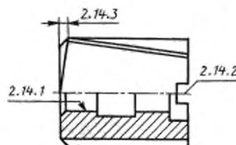
2.14.1 **посадочное отверстие (насадного зенкера):** отверстие насадного зенкера, посредством которого он крепится на оправке
