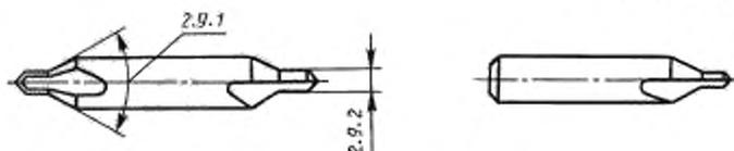
2.9.1 **зенкующий угол (сверла):** угол за сверловочной частью центровочного сверла, который образует конус в заготовке, базирующийся центр
