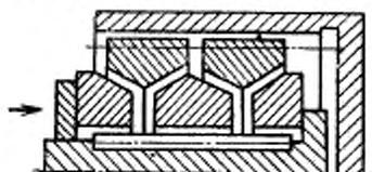
102. Колодочная муфта с переключением: Асинхронная муфта с переключением, у которой управление соединения и разъединения валов осуществляется путем ввода или вывода в зацепление фрикционных поверхностей полуцилиндрических колодок, установленных шарнирно на одной из полумуфт, и внутренней цилиндрической поверхностью второй полумуфты
