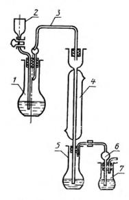
1 — переговная колба; 2 — калельная воронка; 3 — трубка с гидрозатвором; 4 — холодильних; 5 — приеменя; 6 — гидрозатвор; 7 — контрольный приемики.
