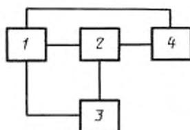
1 – формирователь обрабатываемого сигнала; 2 – измеряемое изделие;
