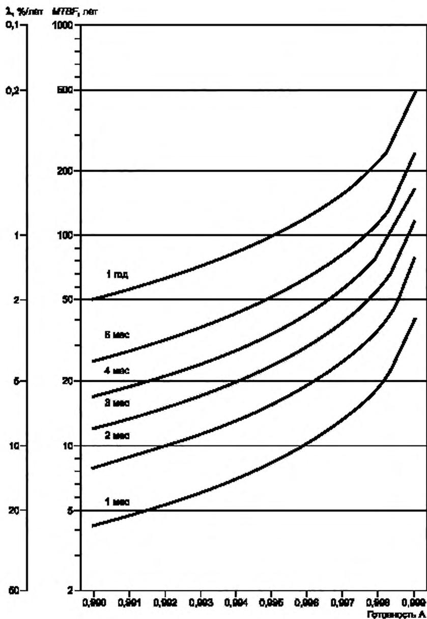
П р и м е ч а н и е — Значения параметров на кривых представляют интервал времени снятия показаний счетчиков.
