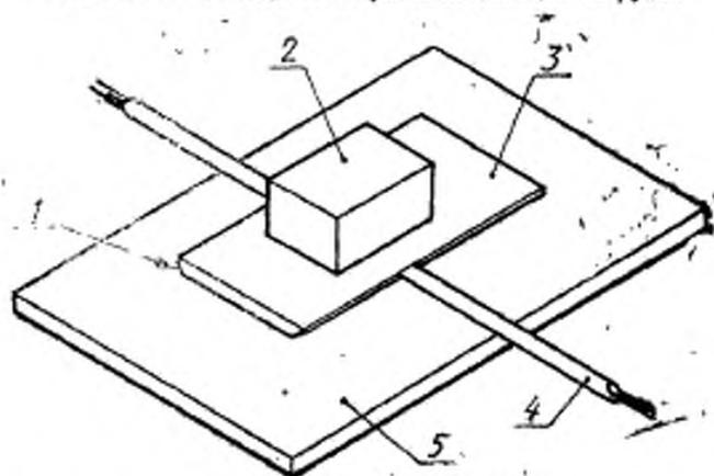
1 — радиус закругления; 2 — груз; 3 — подвижная пластина;
