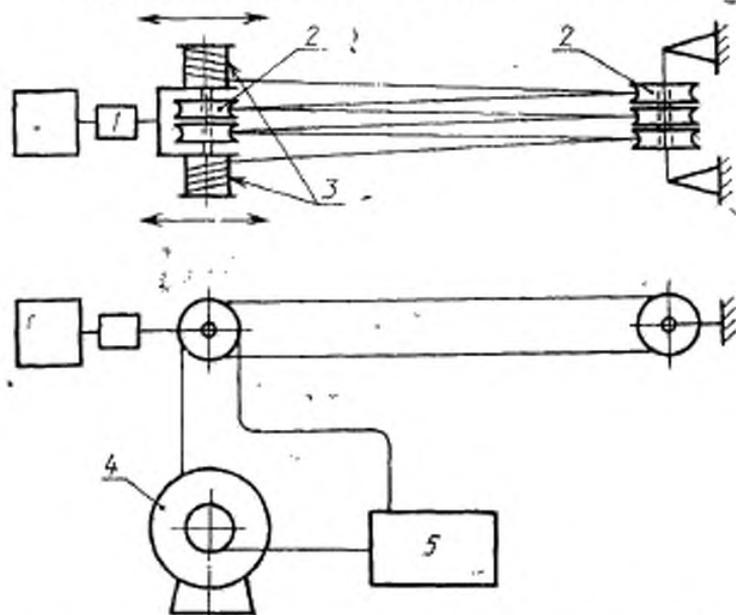
1 — привод; 2 — растягивающие ролики; 3 — барабан (для крепления кабеля); 4 — барабан с кабелем; 5 — прибор для измерения затухания
