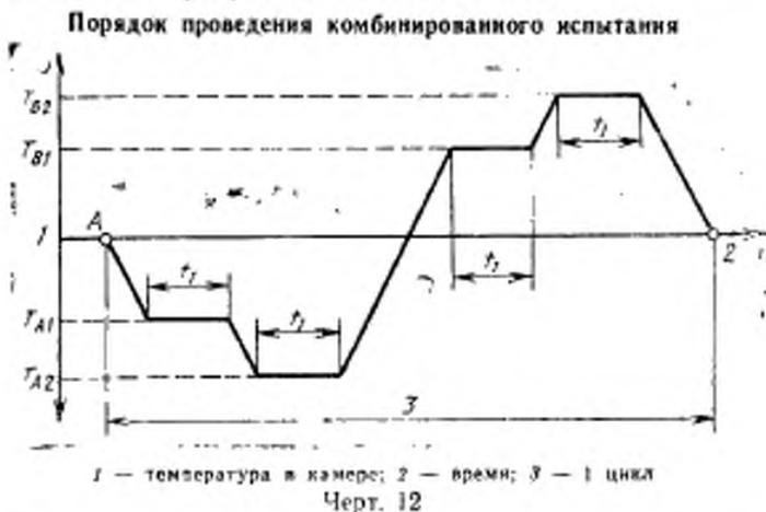
12) Значения  $T_A$ ,  $T_B$  и  $t_i$ , скорость охлаждения (или нагрева) должны быть указаны в НТД на кабели конкретных марок.
