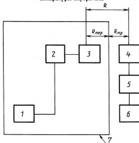
1 — генератор; 2 — аттенюатор; 3 — передающая антенна; 4 — приемная антенна; 5 — аттенюатор; 6 — измерительный приемник; 7 — ЭК
