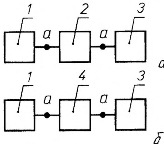
1 — генератор высокочастотных сигналов (встроенный генератор селективного микровольтметра SMV-8,5); 2 — измерительный кабель; 3 — приемное устройство с индикатором (SMV-8,5); 4 — измеряемый фидерный тракт
