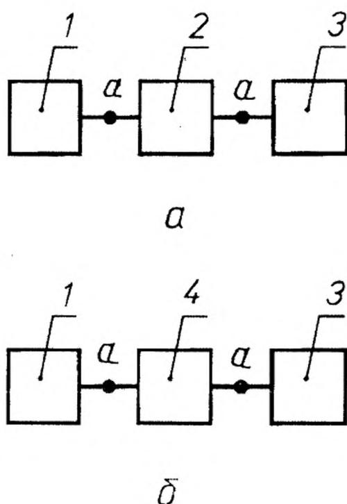
1 — генератор высокочастотных сигналов (встроенный генератор селективного микровольтметра SMV-8.5); 2 — измерительный кабель; 3 — приемное устройство с индикатором (SMV-8.5); 4 — измеряемый фидерный тракт
