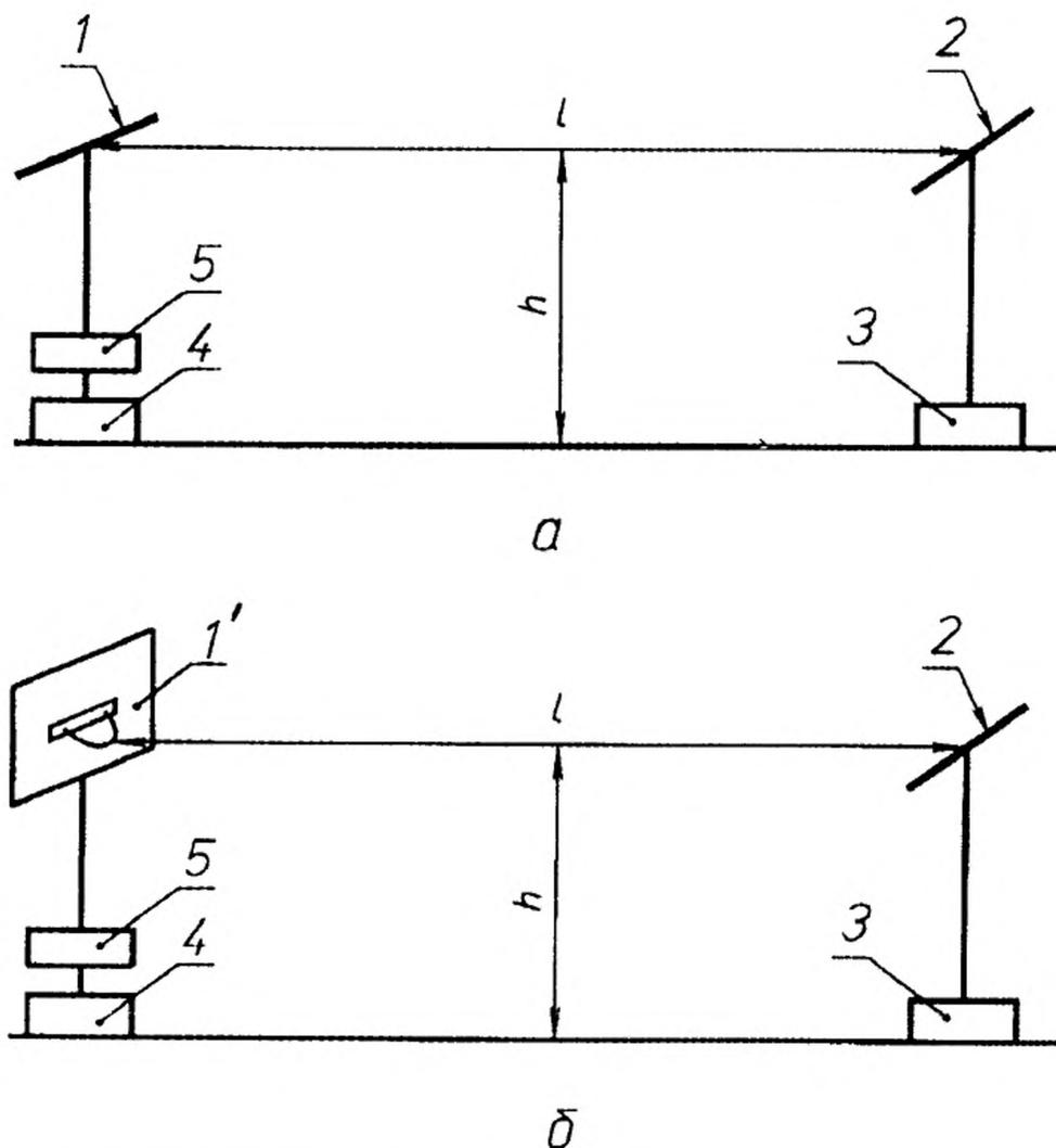
1 — антенна измерительная LPA-1; 1' — измеряемая антенна, размещенная на макете или на металлическом листе; 2 — облучающая антенна; 3 — встроенный генератор высокочастотных сигналов селективного микровольметра SMV-8.5; 4 — микровольметр селективный SMV-8.5; 5 — стелд поворотный
