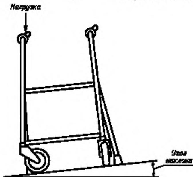
Рисунок 7 — Расположение каталки и приложение нагрузки при испытаниях на статическую боковую устойчивость
