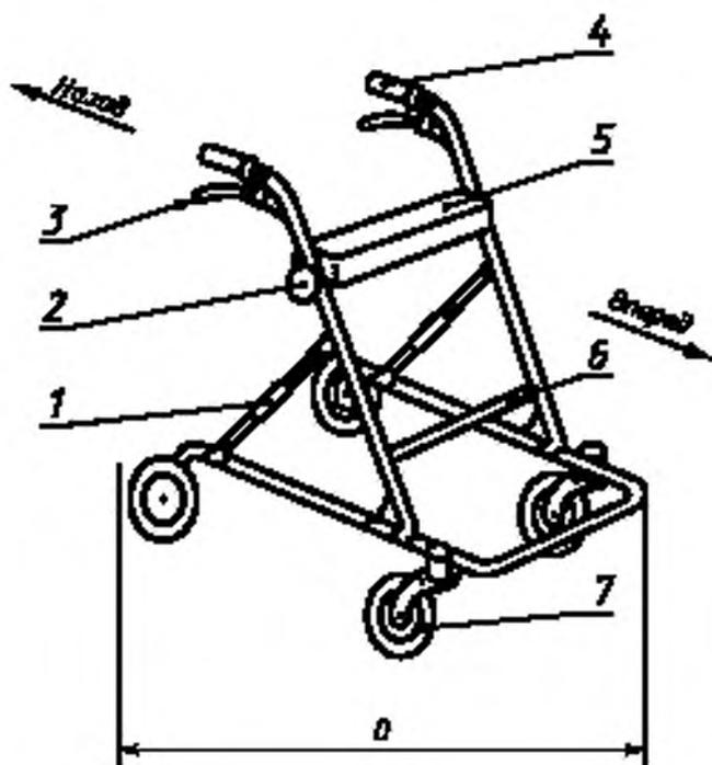
$D$  — диаметр поворота; 1 — механизм складывания;
