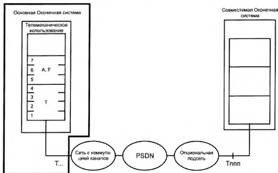
Рисунок 3 — Коммутируемый доступ Оконечной системы (основной Оконечной системы) к сети передачи данных с коммутацией пакетов PSDN
