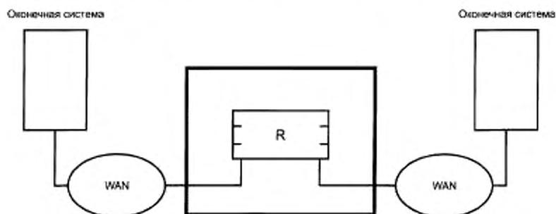
Рисунок 4 — Реле между двумя глобальными сетями WAN
