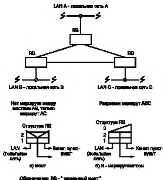
Рисунок 10 — Базовая структура с «удаленными мостами»
