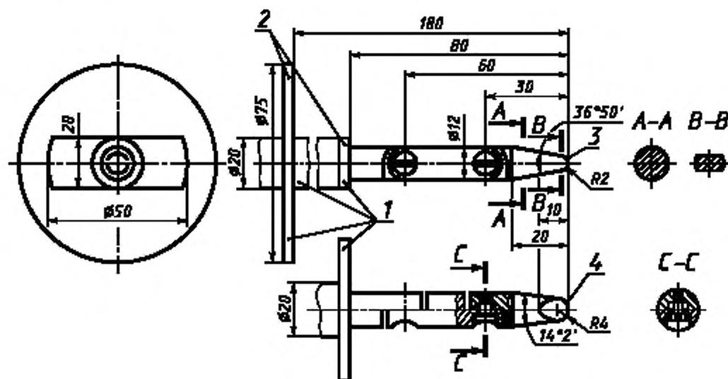
1 — изоляционный материал; 2 — опорная плата; 3 — цилиндр; 4 — сфера
