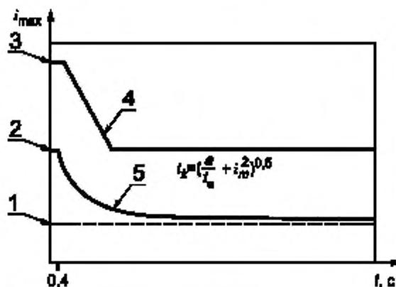
1 — абсолютный минимум  $i_{\min}$ ; 2 —  $i_e$  при  $t_c = 0,4$  с; 3 — эффективный ток предварительного подогрева; 4 — максимальный эффективный ток предварительного подогрева в любой момент времени  $t$ ; 5 — предел минимального эффективного тока предварительного подогрева за время  $t$
