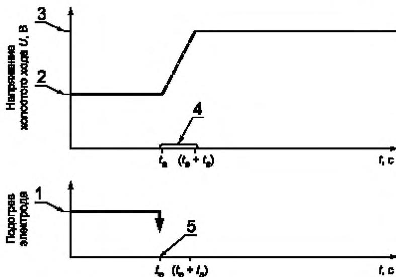
1 —  $i_k$  до  $t_0$ ; 2 —  $U$  до  $t_0$ ; 3 —  $U$  после  $t_0$ ; 4 — продолжительность переходного периода  $t_0 = 100$  мс, не более;
