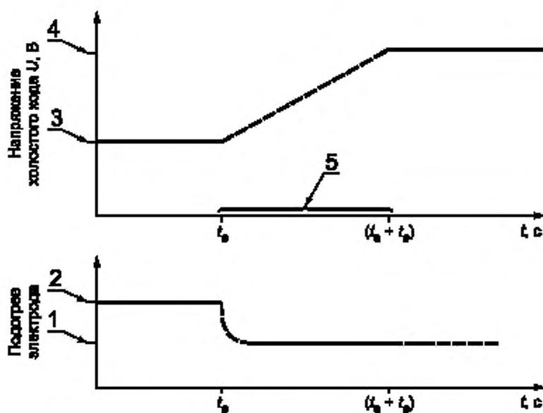
1 —  $\geq i_k$  до зажигания лампы; 2 —  $i_k$  до  $t_0$ ; 3 —  $U$  до  $t_0$ ; 4 —  $U$  после  $t_0$ ; 5 — продолжительность переходного периода  $t_0 \geq 100$  мс
