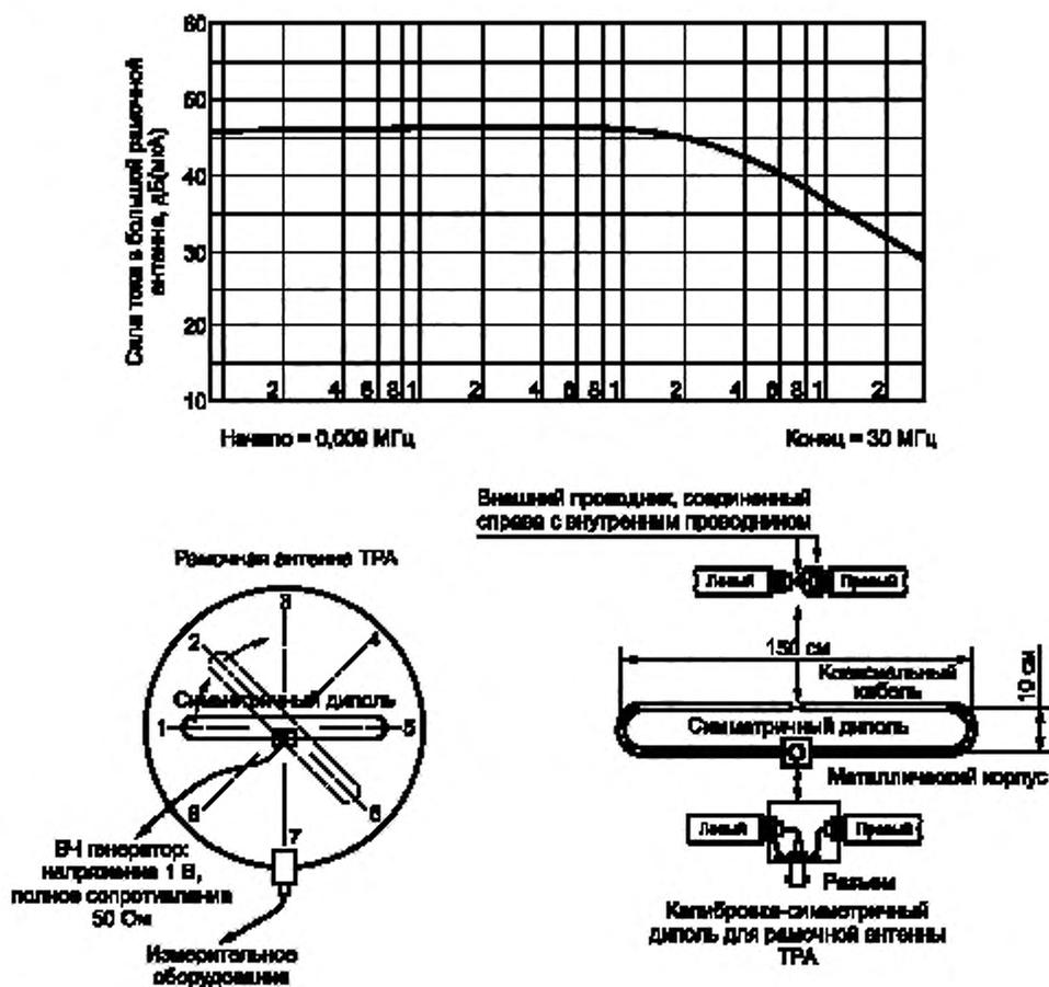
Рисунок Б.4 — Испытательная установка для оценки ТРА
