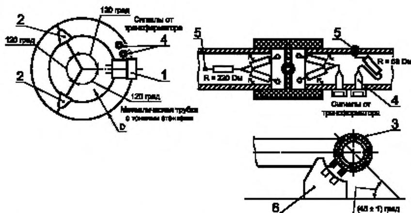
1 — стандартный цоколь с взаимосвязанными штырями; 2 — подставка из изолирующего материала; 3 — деталь соединительных зажимов 1, показывающая соединение с металлической трубкой; 4 — гнезда, соединенные с симметрирующим трансформатором; 5 — проводники, подсоединенные к металлической трубке; 6 — розетка светильника
