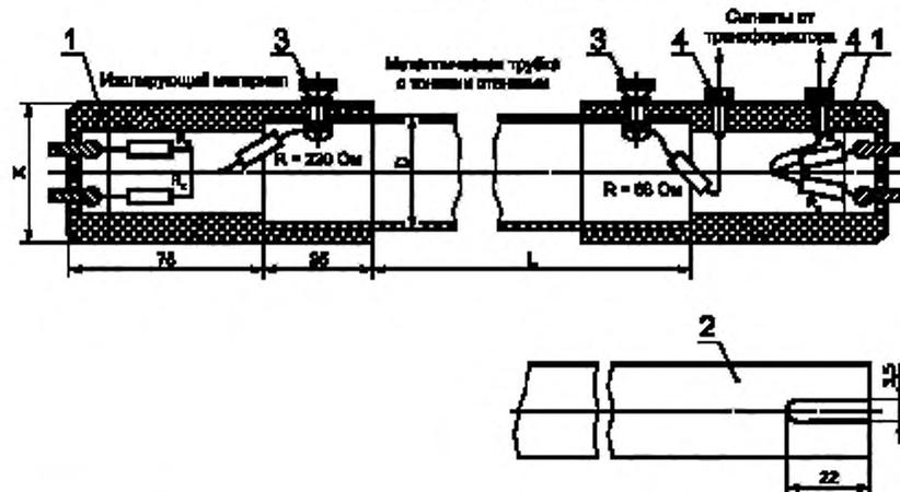
1 — стандартный цоколь с взаимосвязанными штырями; 2 — детализация металлической трубки (изогнута соответствующим образом для U-образных ламп); 3 — винт с гайкой для электрического и механического соединения металлической трубки с цоколем эквивалента лампы; 4 — гнезда, соединенные с симметрирующим трансформатором
