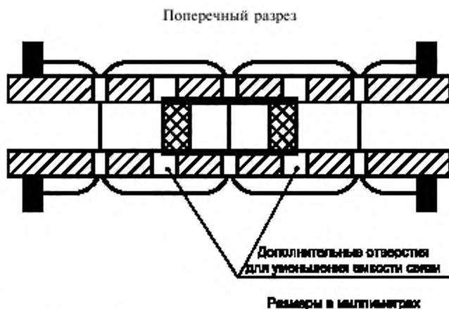
Рисунок А.2в — Детали конструкции сердечника трансформатора
