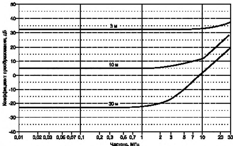
Примечание — Сила тока, дБ(мкА/м) + коэффициент преобразования, дБ(Ом/м) = напряженности магнитного поля, дБ(мкВ/м) (расстояние измеряют от центров испытываемых приборов и антенн)
