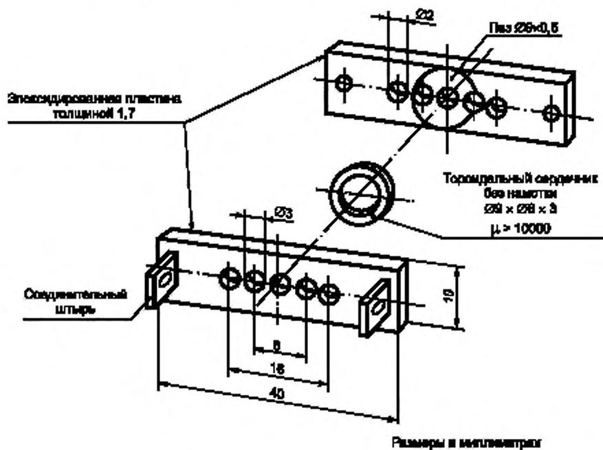
Рисунок А.2б — Детали конструкции сердечника трансформатора
