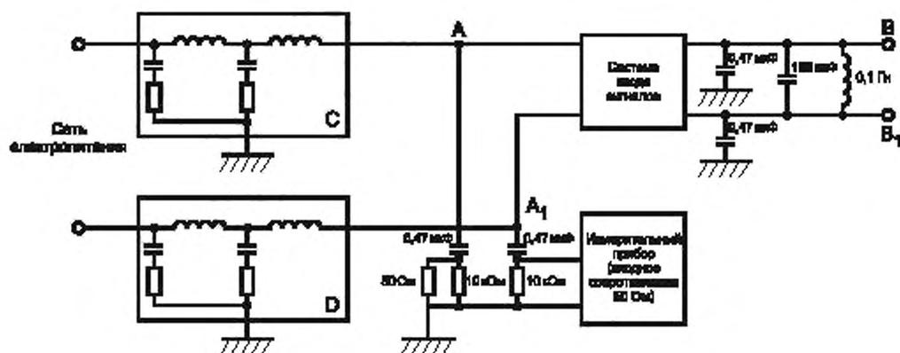
B, B<sub>1</sub> — точки измерений уровней выходных сигналов в электрической сети потребителя электрической энергии; C, D — эквиваленты сети (см. рисунок 5)
