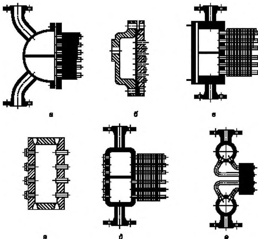
а, б, в — разъемные камеры на давление до 6,3 МПа; г, д — цельносварные камеры с пробками на давление до 10,0 МПа, е — трубчатые камеры на давление свыше 10,0 МПа
