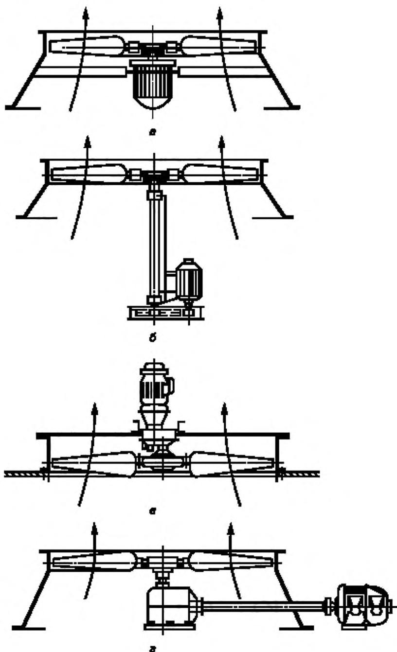
а — непосредственный; б — клиноременный; в — редуктор с параллельными валами;
