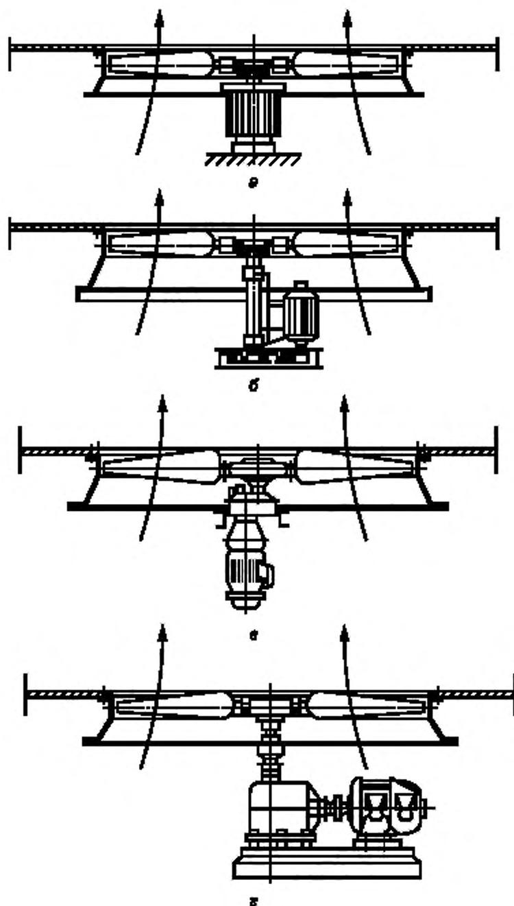
а — непосредственный; б — клиноременный; в — редуктор с параллельными валами;
