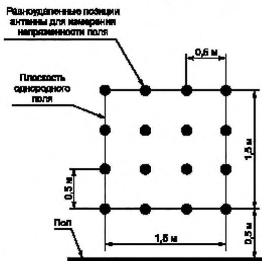
Рисунок 4 — Размеры плоскости однородного поля
