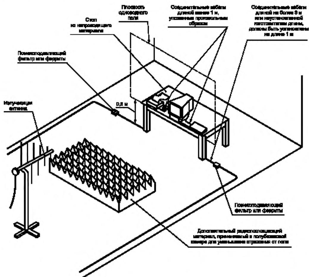
Рисунок 6 — Пример рабочего места для испытаний настольных ТС
