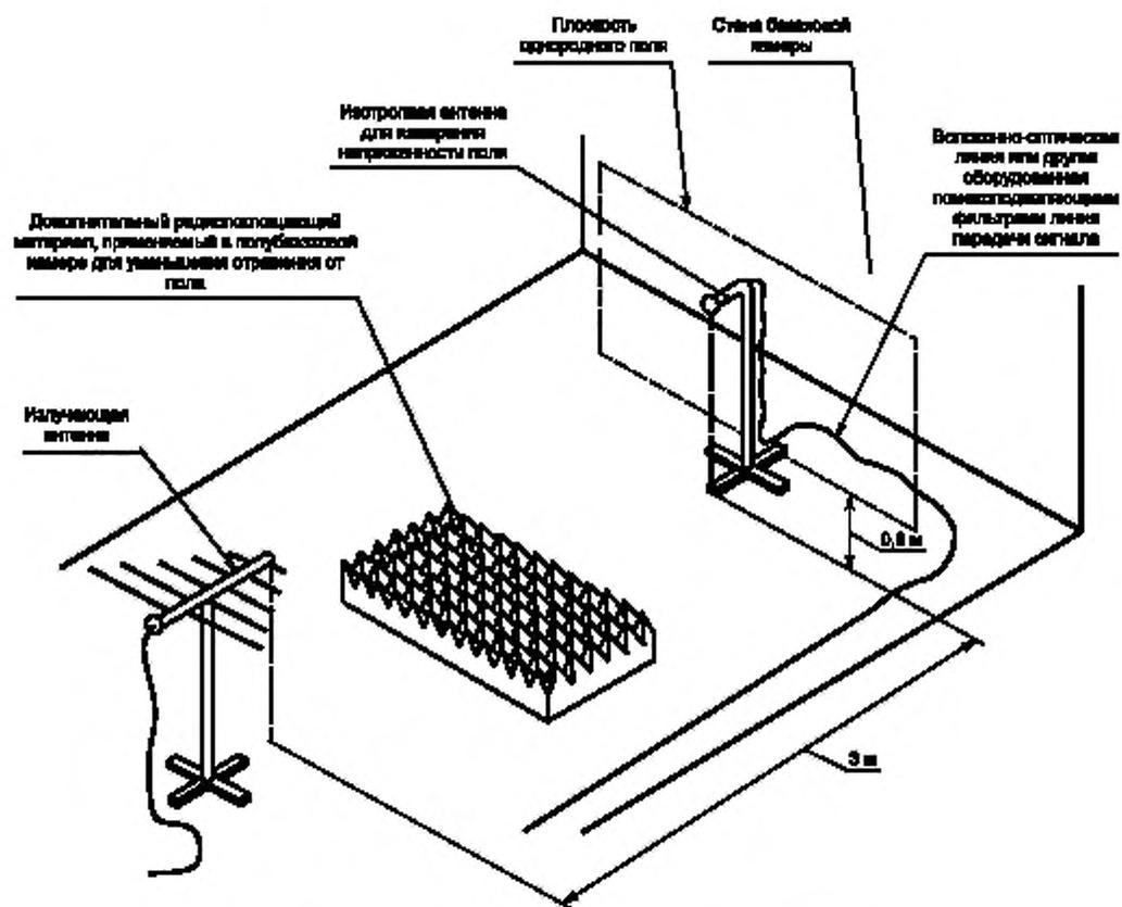
Рисунок 3 — Расположение оборудования при аттестации
