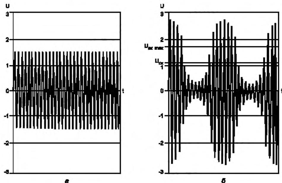
а — немодулированный радиочастотный сигнал (амплитудное значение напряжения  $U_a = 1,4$  В, среднеквадратичное значение напряжения  $U_{\text{СК}} = 1$  В);
