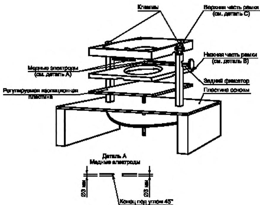
Рисунок 107а — Аппарат для испытания «на искру»
