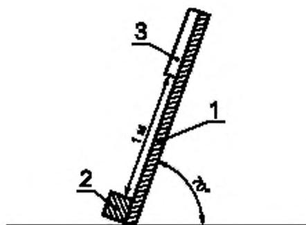
1 — гладкая наклонная плоскость; 2 — упорная колодка; 3 — испытываемая ПОДУШКА
