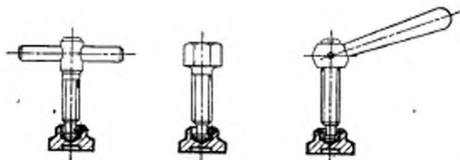
Изменение № 3 ГОСТ 13437—68 Пяты увеличенные для нажимных винтов станочных приспособлений, Конструкция и размеры
