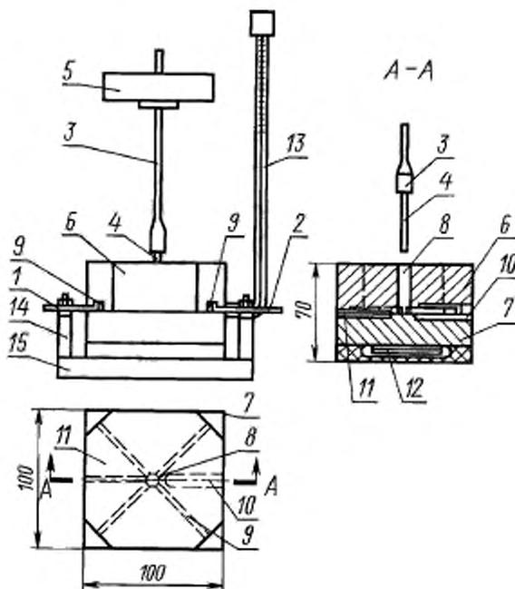
1 и 2 – образцы провода; 3 – стержень; 4 – керамический наконечник; 5 – груз; 6 – верхняя плита; 7 – нижняя плита; 8 – отверстие для стержня; 9 – прорезы для образцов провода; 10 – отверстие для термометра; 11 – отверстие для термопары; 12 – нагревательный элемент; 13 – терморегулятор; 14 – клеммы для закрепления образцов и подключения к ним напряжения; 15 – изолированная подставка
