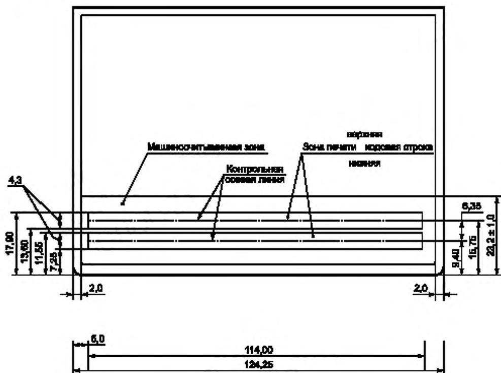
Рисунок 5 — Схематическая диаграмма МСЗ
