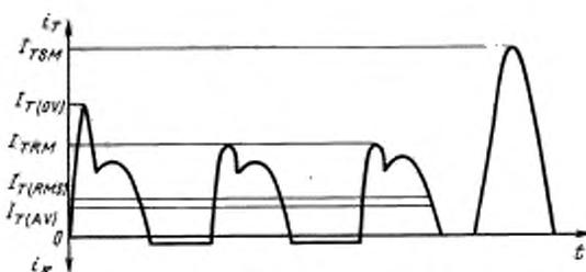
$I_{T(AV)}$  — средний ток в открытом состоянии;  $I_{T(RMS)}$  — действующий ток в открытом состоянии;  $I_{TRM}$  — повторяющийся импульсный ток в открытом состоянии;  $I_{T(OV)}$  — ток перегрузки в открытом состоянии;  $I_{TSM}$  — ударный ток в открытом состоянии
