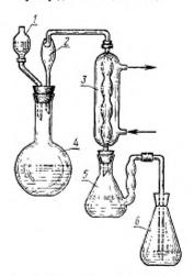
Г — капедьная воронка; 2 — борзгоумавливатель; 3 — хододильник; 4 перегония колба; 5 — приемик для улавливания аммеака; 6 колба-ловушка для аммеака;
