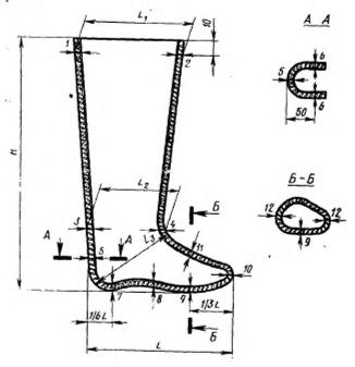
2.1.2. Длину следа внутри обуви измеряют следомером или номерным линейным шаблоном, вставляемым внутрь обуви.
