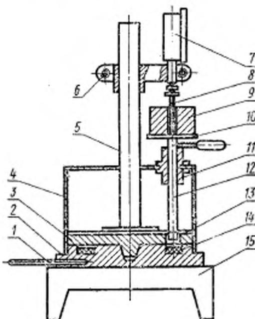
1—термометр; 2—нижняя плита; 3—верхняя плита; 4—корпус; 5—стойка; 6—держатель индикаторов; 7—индикатор; 8—узел индикатора; 9—груз; 10—площадка груза; 11—выравнивающая втулка; 12—шток; 13—пуансон; 14—образец; 15—нагреватель.
