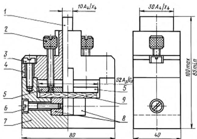
1 — подвижной нож; 2 — винт зажима образца; 3 — винт крепления крышки; 4 — крышка;
