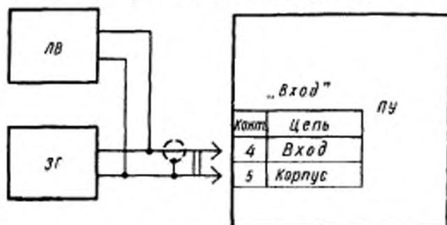
ЛВ — ламповый вольтметр; ЗГ — звуковой генератор; ПУ — прибор управления
