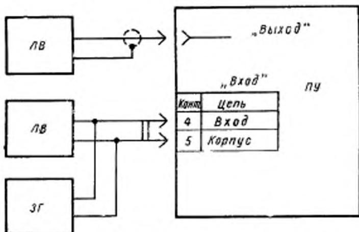
ЛВ—ламповый вольтметр, ЗГ—звуковой генератор; ПУ—прибор управления
