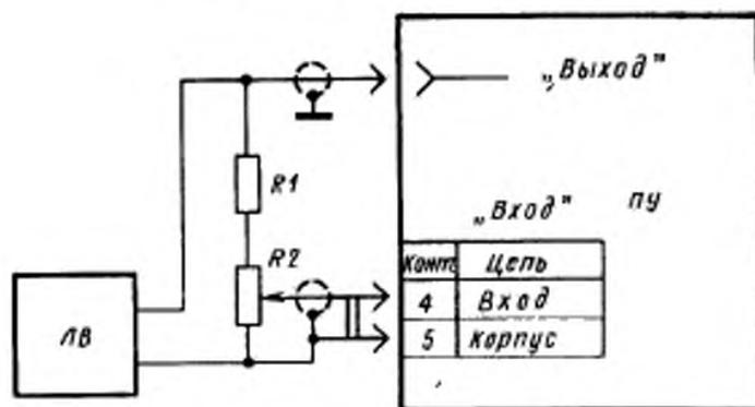
ЛВ — датчиковый вольтметр; ПУ — прибор управления; R1 — резистор МЛТ-1—12 кОм ± 5%;
