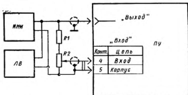
ИНИ — измеритель нелинейных искажений; ЛВ — ламповый вольтметр;
