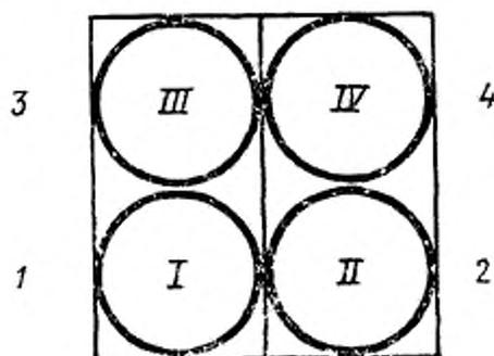
В отверстие 1 помещают пробирку с половиной анализируемого раствора, содержащего реактив.
