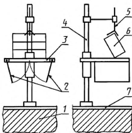
1 — фундамент; 2 — створки; 3 — рама; 4 — стойка; 5 — фиксатор; 6 — испытуемый образец; 7 — стальная плита
