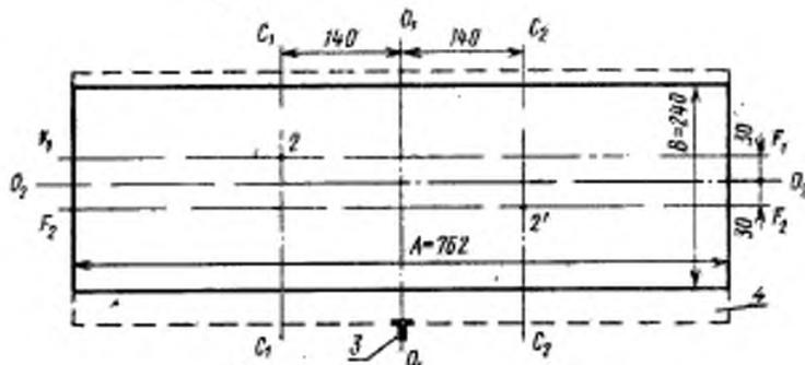
1—трубчатая ксеноновая лампа; 2, 2'—центры угольных дуговых ламп (дуги); 3—крестовина вала барабана; 4—экспозиционный барабан; A—расстояние между противоположными образцами, расположенными в вертикальных кассетах; B—высота зоны облучения;  $O_1O_2$ —вертикальная ось симметрии зоны облучения;  $O_1O_2$ —горизонтальная ось симметрии зоны облучения;  $C_1C_1$  и  $C_2C_2$ —оси первого и второго источников облучения;  $F_1F_1$  и  $F_2F_2$ —линии центров угольных дуговых ламп.
