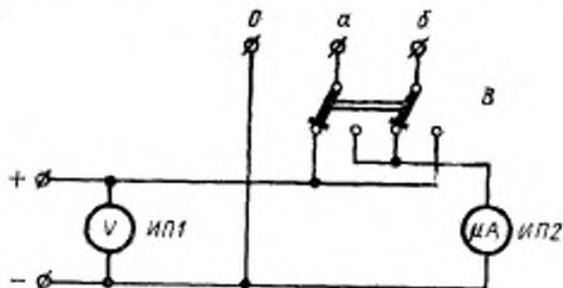
ИП1 — вольтметр постоянного тока; В — переключатель полярности напряжения; α и β — контакты, предназначенные для присоединения электродов, металлического баллона или подогревателя, между которыми измеряют сопротивление изоляции; θ — контакт, являющийся общей точкой схемы; ИП2 — электронный или магнитоэлектрический микроамперметр постоянного тока
