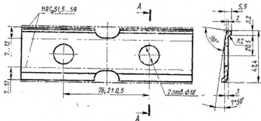
Примечание. Допускается смещение осей отверстий в продольном направлении относительно оси симметрии детали до 12 мм.
