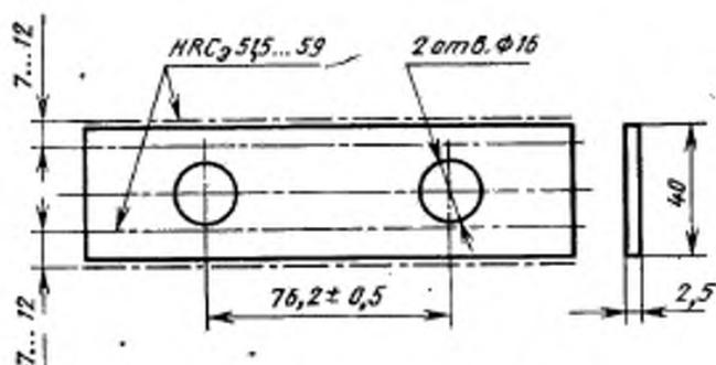
Примечание. Допускается применение крепежных отверстий по типу отверстий исполнения 1.
