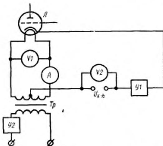
*A*—амперметр; *V1*, *V2*—вольтметры; *L*—испытываемая лампа; *Tp*—трансформатор напряжения накала; *Y1*—индикатор короткого замыкания; *U2*—прерыватель напряжения накала; *U<sub>k-h</sub>*—источник напряжения катод—подогреватель
