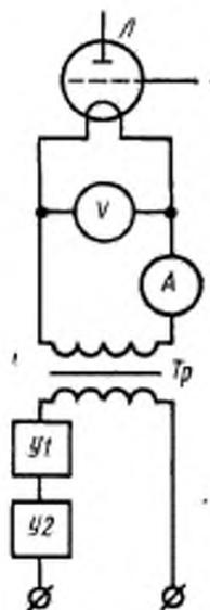
А—амперметр; V—вольтметр; Л—испытываемая лампа; Тр—трансформатор напряжения накала; У1—ограничительное устройство (резистор); У2—прерыватель напряжения
