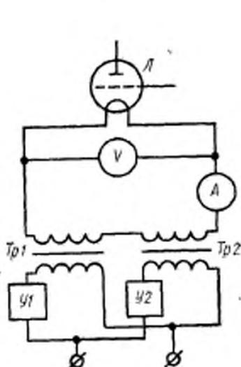
А—амперметр; V—вольтметр; Л—испытываемая лампа; Тр1, Тр2—трансформаторы напряжения накала; У1, У2—прерыватели напряжения накала
