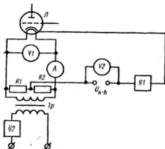
*R1*, *R2*—резисторы; *A*—амперметр; *V1*, *V2*—вольтметры; *L*—испытываемая лампа; *Tp*—трансформатор напряжения накала; *Y1*—индикатор короткого замыкания; *U2*—прерыватель напряжения накала; *U<sub>k-h</sub>*—источник напряжения катод—подогреватель
