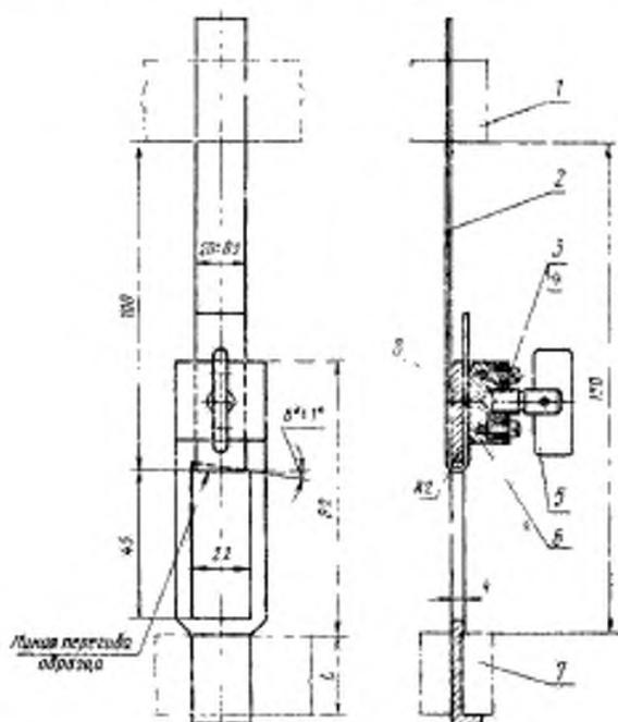
1 — верхний зажим; 2 — образец; 3 — винт специальный; 4 — пружина;
