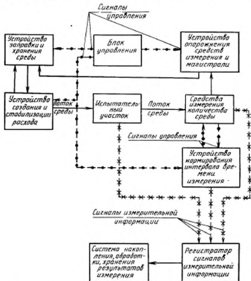
2. Поверочная расходомерная установка должна состоять из элементов, указанных в структурной схеме:
