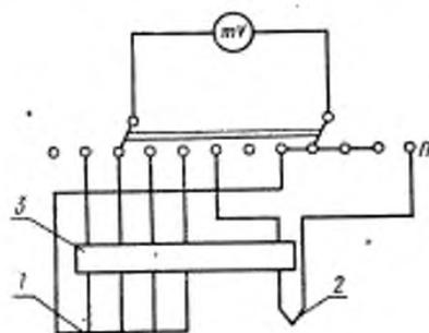
1—связка образцов; 2—образцовый 2-го разряда медьконстантановый термоэлектрический термометр; 3—сосуд Дьюара с тапками льдом; 4—бестермоточный переключатель; mV—потенциометр
