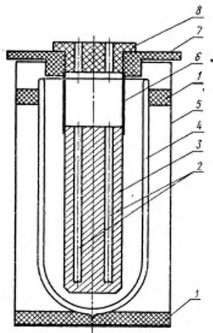
1—резиновая или пенопластовая прокладка; 2—гнездо; 3—медный блок; 4—сосуд Дьюара; 5—корпус; 6—подвеска из нержавеющей стали; 7—текстолитовый фланец; 8—текстолитовая крышка
