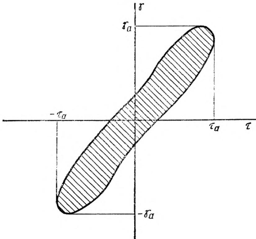
$\gamma_a$  — амплитуда деформации;  $\tau_a$  — амплитуда напряжения
