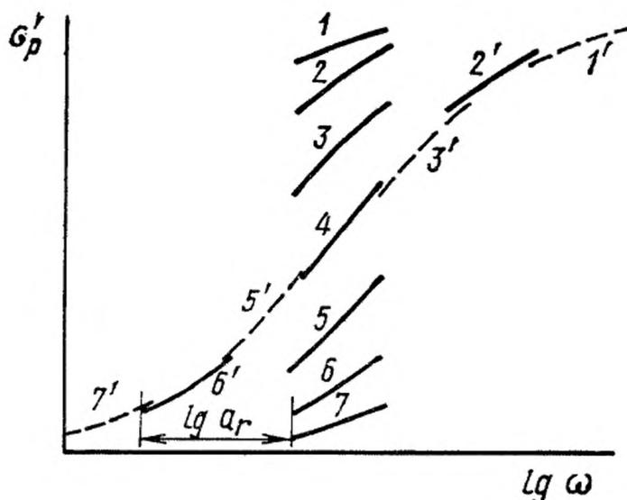
Метод температурно-частотного приведения можно применять в интервале температур от  $T_c$  до  $T_c + 100^\circ\text{C}$  для ненаполненных резин на основе аморфных каучуков в предположении, что структура резины не меняется в процессе испытания в вышеуказанном интервале температур. С меньшим успехом этот метод можно применять для саженаполненных резин из-за большого разброса экспериментальных точек на обобщенной кривой, что связано с тиксотропным поведением саженаполненных резин.
