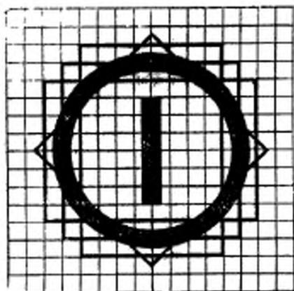
22. Бесступенчатое регулирование
