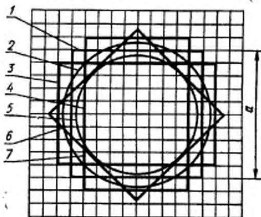
1—основной квадрат со стороной, равной 10 модулям (80 мм); 2—основной круг диаметром, равным 11 модулям (88 мм); 3—прямоугольник 8×12 модулей (64×96 мм); 4—прямоугольник 12×8 модулей (96×64 мм); 5—малый круг диаметром, равным 9 модулям (72 мм); 6—средний квадрат с диагональю, равной 13 модулям (104 мм), повернутый относительно основного квадрата на 45°; 7—малый квадрат со стороной, равной 8 модулям (64 мм)
