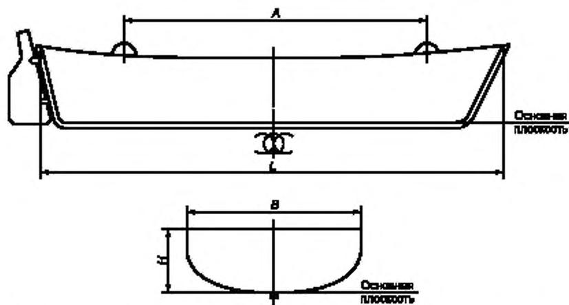
$L$  — расстояние между проекциями на основную плоскость точек пересечения наружной поверхности обшивки с форштевнем и ахтерштевнем (транцем);  $B$  — наибольшая ширина между наружными поверхностями обшивки;  $H$  — высота борта, измеренная вертикально от основной плоскости до нижней кромки планширя;  $A$  — расстояние между осевыми линиями подъемных гаков
