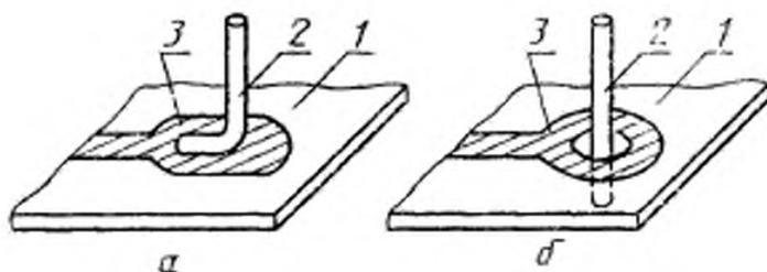
1—плата; 2—проволока; 3—контактная площадка (металлированное отверстие)
