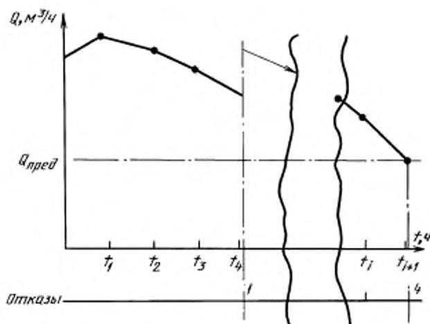
$t_i$  — наработка на момент измерения;  $Q$  — подача;  $Q_{пред}$  — предельно допустимое значение подачи (достижение  $Q_{пред}$  означает параметрический отказ)
