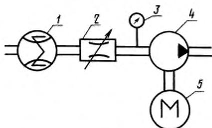
1 — устройство для измерения подачи воздуха; 2 — дроссель; 3 — мановакуумметр; 4 — испытуемый насос; 5 — привод
