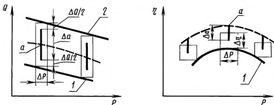
1 и 2 — кривые, ограничивающие полосу допустимых отклонений;  $a$  — номинальное значение параметра;  $\Delta a$  — допуск на параметр;  $\Delta P$ ,  $\Delta Q$ ,  $\Delta H$  — относительные погрешности результатов испытаний
