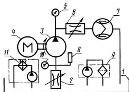
1 — бак; 2 — дроссель всасывающего трубопровода; 3 — испытуемый насос; 4 — привод; 5 — манометр; 6 — дроссель нагнетательного трубопровода; 7 — устройство для измерения подачи; 8 — термометр; 9 — фильтр (фильтровальная установка); 10 — мановакуумметр; 11 — теплообменник
