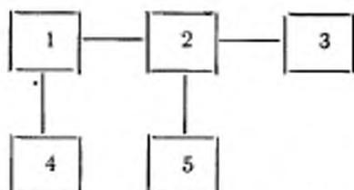
1 — развязывающее устройство; 2 — поверяемая измерительная линия; 3 — нагрузка, рассогласованная с переменной фазой; 4 — генератор сигналов; 5 — индикаторный прибор
