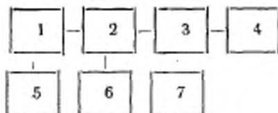
1 — разъемное устройство; 2 — поверхность измерительной линии; 3 — вспомогательная измерительная линия; 4 — короткозамкнутая нагрузка с постоянной фазой; 5 — генератор сигнала; 6, 7 — индикаторные приборы
