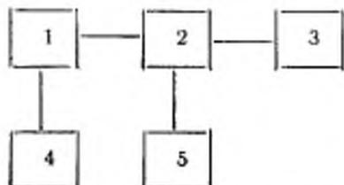
1 — развязывающее устройство (ослабление не менее 20 дБ); 2 — поверяемая измерительная линия; 3 — короткозамкнутая нагрузка с переменной фазой; 4 — генератор сигналов; 5 — индикаторный прибор
