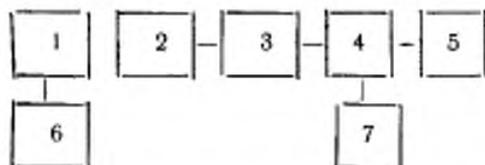
1, 3 — развязывающие устройства с КСВН не более 1,2; 2 — поляризационный аттенюатор; 4 — поверяемая измерительная линия; 5 — образцовая нагрузка; 6 — генератор сигналов; 7 — индикаторный прибор.
