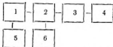
1 — разъемное устройство; 2 — поверхность измерительной линии; 3 — детекторная головка; 4, 6 — индикаторы; 5 — генератор сигнала
