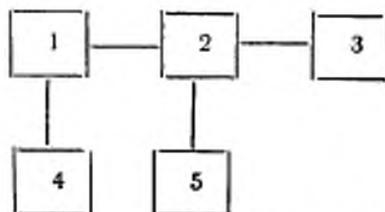
1 — развязывающее устройство; 2 — повреждаемая измерительная линия; 3 — короткозамкнутая нагрузка; 4 — генератор сигналов; 5 — индикаторный прибор проверяемой линии
