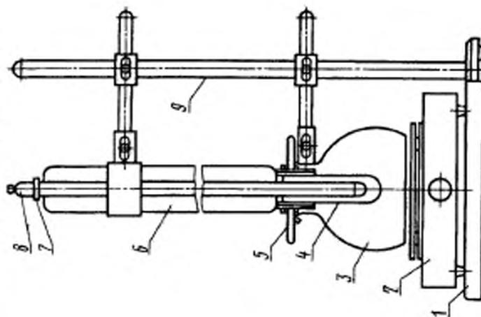
1 — подставка; 2 — электролитика; 3 — стеклянный отражатель; 4 — пробирка; 5 — держатель; 6 — трубка направляющая для термометра; 7 — резиновое кольцо; 8 — термометр; 9 — штатив
