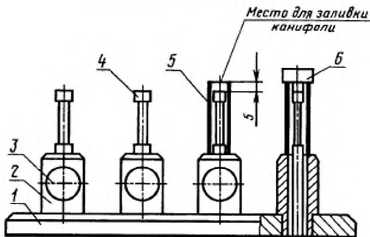
1 — плита; 2 — втулка; 3 — винт; 4 — стержень; 5 — стеклянная трубка,
